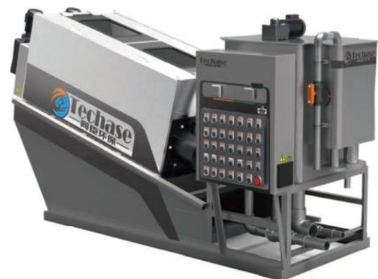
河湖清淤专用叠螺机集全自动控制柜、絮凝调质槽、浓缩脱水本体及集液槽于一体，可在全自动运行的条件下，实现高效絮凝，并连续完成浓缩和压榨脱水工作，最终将收集的滤液回流或排放。河湖清淤专用叠螺机也可**船载**设计。
