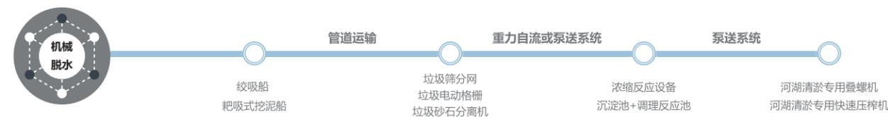
被挖出的淤泥输送至岸上后，陆续经过垃圾分拣设备、砂水分离设备的处理，进入淤泥浓缩装置，其中淤泥浓缩装置按照项目情况，可采用重力浓缩池或者叠螺式浓缩机进行处理，将河湖淤泥的含水率降至90%以下。对有机质含量高、难脱水淤泥可进行化学调理。淤泥经浓缩、调理后，泵送至河湖清淤专用叠螺机或河湖清淤专用快速压榨机，将淤泥进行快速脱水。尾水经静沉、过滤工艺后返回水体或纳管。
